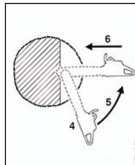
4 = Шину устанавливать нижней, а не верхней стороной вершины – Возможна отдача!
