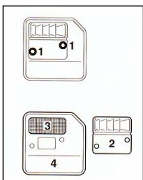
При падении мощности двигателя контролируйте искрозащитную решетку\* в шумоглушителе.
