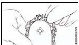
Наденьте защитные перчатки – Опасность травмы острыми режущими зубьями.
