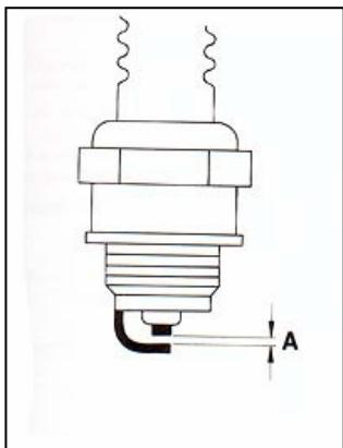
При недостаточной мощности двигателя, при плохом запуске или перебоях на холостом ходу в первую очередь следует проверить состояние свечи зажигания.
