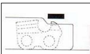
Ограничитель глубины опиливать параллельно нанесенной маркировке.
