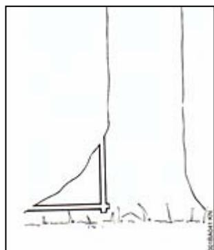
Подпилить большие прикорневые наплывы: первым должен подпиливаться наибольший корневой наплыв – сначала вертикально, затем горизонтально.
