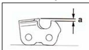
Ограничитель глубины определяет глубину врезания в древесину, т.е. глубину стружки. Заданное расстояние между ограничителем глубины и режущей гранью = **a**:
